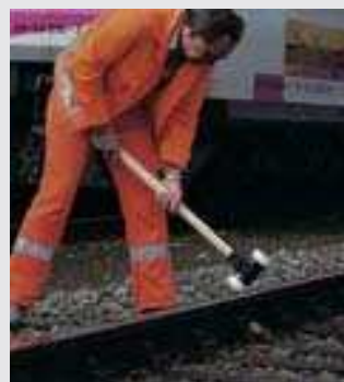
Die pulverbeschichteten Sicherheitschalen aus Temperguß klemmen Kopf und Stiel sicher zusammen. Der 840 mm lange Vorschlaghammer hat die ideale Länge für spezielle Einsatzgebiete, z.B. beim Gleisbau.
