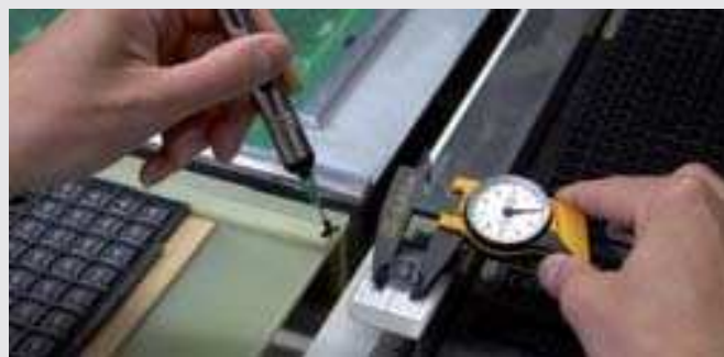
Der dialMax® ESD Messschieber ermöglicht Messarbeiten an empfindlichen elektronischen Bauteilen.
